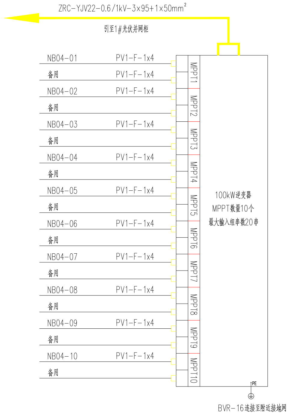
NB05接线方式(接10串)
